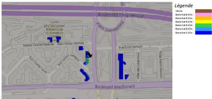
Pour les antennes à faisceau orientable dans l'azimut 250°, le niveau maximal calculé est compris entre 2 et 3 V/m. La hauteur correspondante est de 19.5 m.
