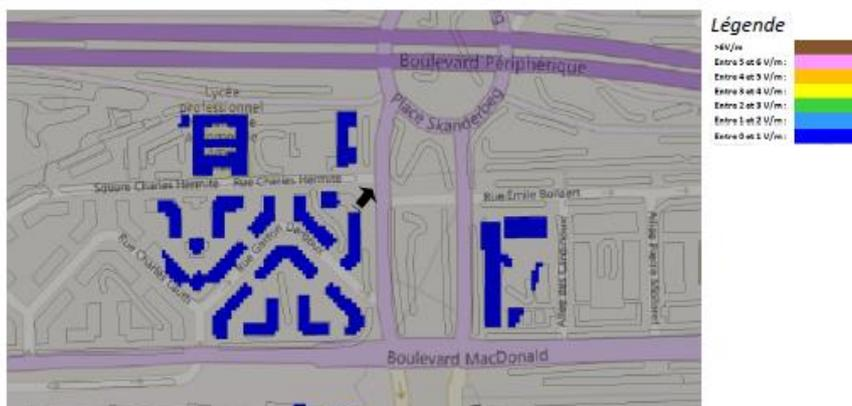
Pour les antennes à faisceau orientable dans l'azimut 140°, le niveau maximal calculé est compris entre 2 et 3 V/m. La hauteur correspondante est de 22.5 m.
