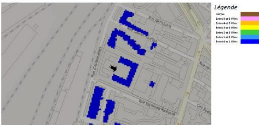
Pour les antennes à faisceau orientable dans l'azimut 240°, le niveau maximal calculé est compris entre 0 et 1 V/m . La hauteur correspondante est de 22.5 m .
