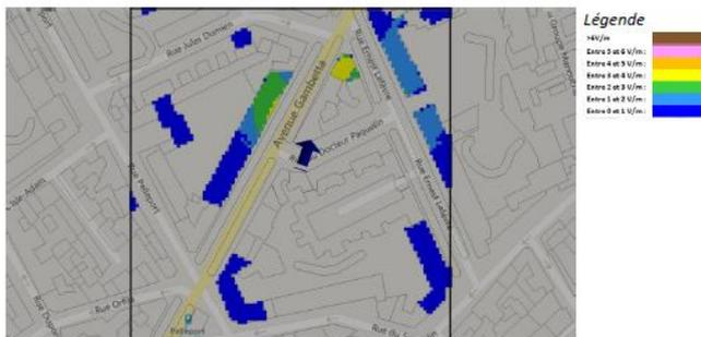
Pour l'antenne orientée dans l'azimut 130°, le niveau maximal calculé est compris entre 3 et 4 V/m . La hauteur correspondante est de 25.5 m .
