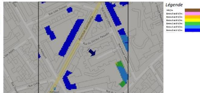
Pour l'antenne orientée dans l'azimut 230°, le niveau maximal calculé est compris entre 4 et 5 V/m . La hauteur correspondante est de 25.5 m .
