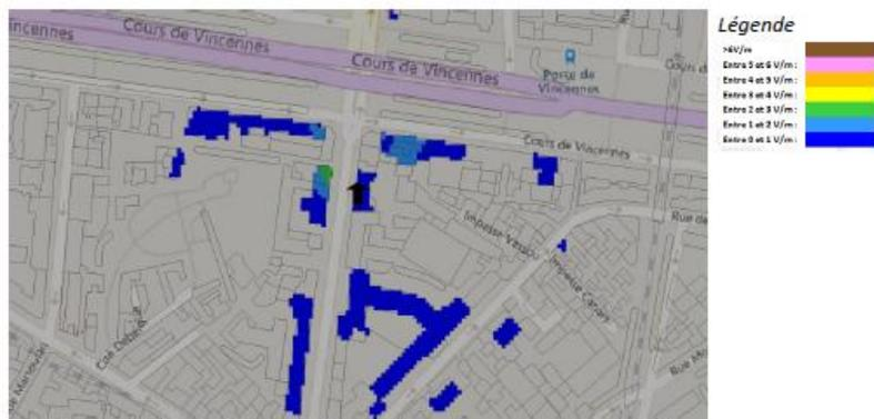
Pour les antennes à faisceau fixe orientées dans l'azimut 120°, le niveau maximal calculé est compris entre 2 et 3 V/m . La hauteur correspondante est de 22.5 m .
