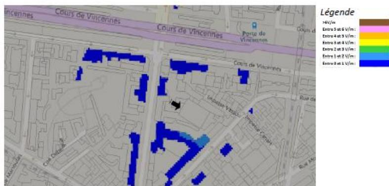
Pour les antennes à faisceau orientable dans l'azimut 220°, le niveau maximal calculé est compris entre 2 et 3 V/m . La hauteur correspondante est de 25.5 m .
