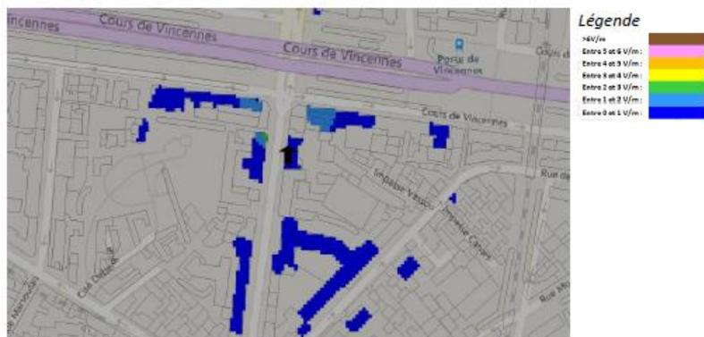
Pour les antennes à faisceau orientable dans l'azimut 120°, le niveau maximal calculé est compris entre 1 et 2 V/m . La hauteur correspondante est de 22.5 m .
