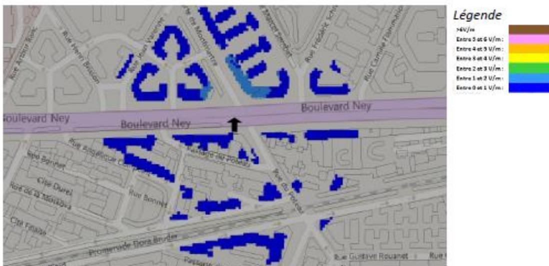
Pour les antennes à faisceau orientable dans l'azimut 120°, le niveau maximal calculé est compris entre 2 et 3 V/m . La hauteur correspondante est de 25.5 m .
