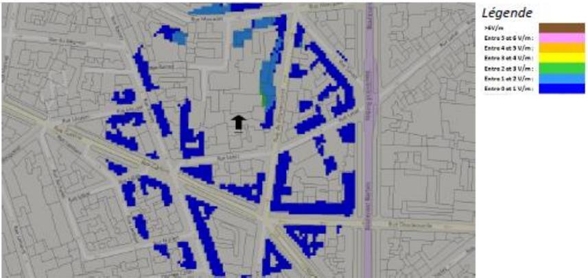
Pour les antennes à faisceau orientable dans l'azimut 120°, le niveau maximal calculé est compris entre 3 et 4 V/m . La hauteur correspondante est de 16.5 m .
