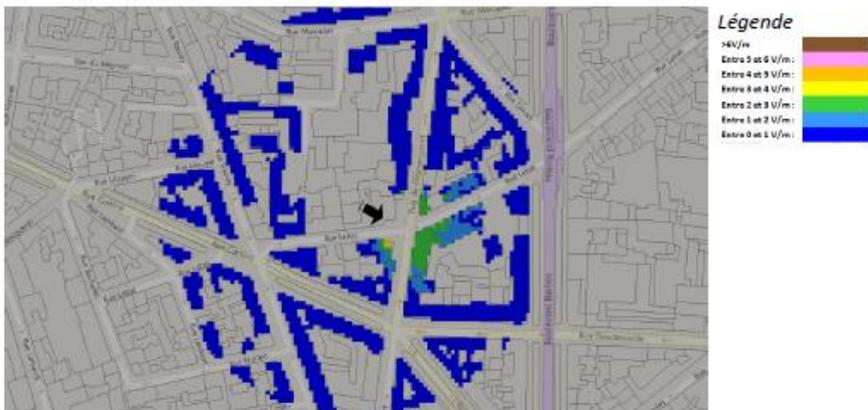
Pour les antennes à faisceau orientable dans l'azimut 240°, le niveau maximal calculé est compris entre 3 et 4 V/m . La hauteur correspondante est de 19.5 m .
