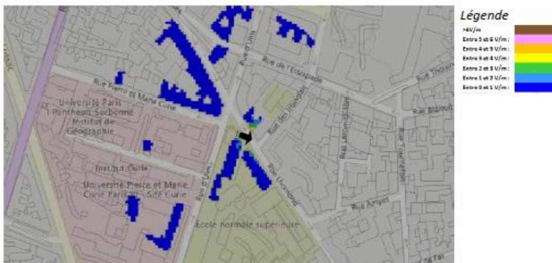
*Pour les antennes à faisceau orientable dans l'azimut 230°, le niveau maximal calculé est compris entre 2 et 3 V/m . La hauteur correspondante est de 22.5 m .*
