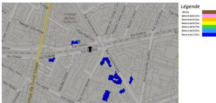
Pour les antennes à faisceau orientable dans l'azimut 150°, le niveau maximal calculé est compris entre 2 et 3 V/m . La hauteur correspondante est de 25.5 m .
