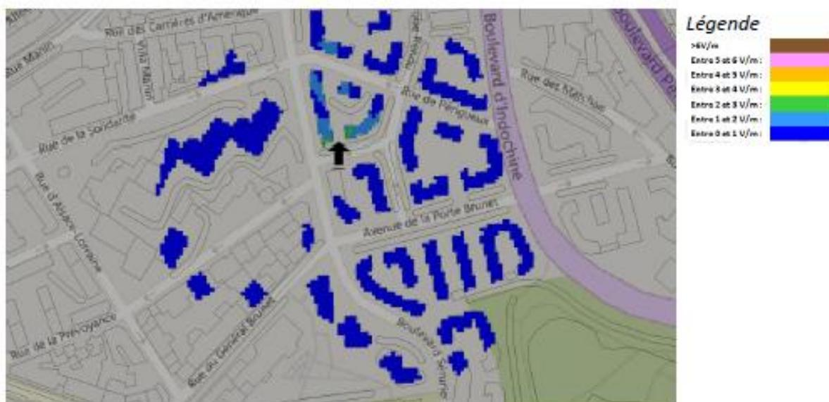
*Pour les antennes à faisceau orientable dans l'azimut 120°, le niveau maximal calculé est compris entre 2 et 3 V/m . La hauteur correspondante est de 19.5 m .*
