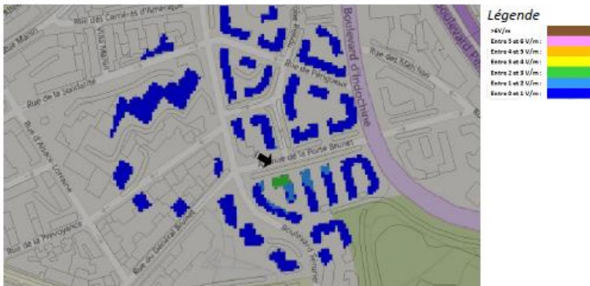
*Pour les antennes à faisceau orientable dans l'azimut 240°, le niveau maximal calculé est compris entre 3 et 4 V/m . La hauteur correspondante est de 16.5 m .*
