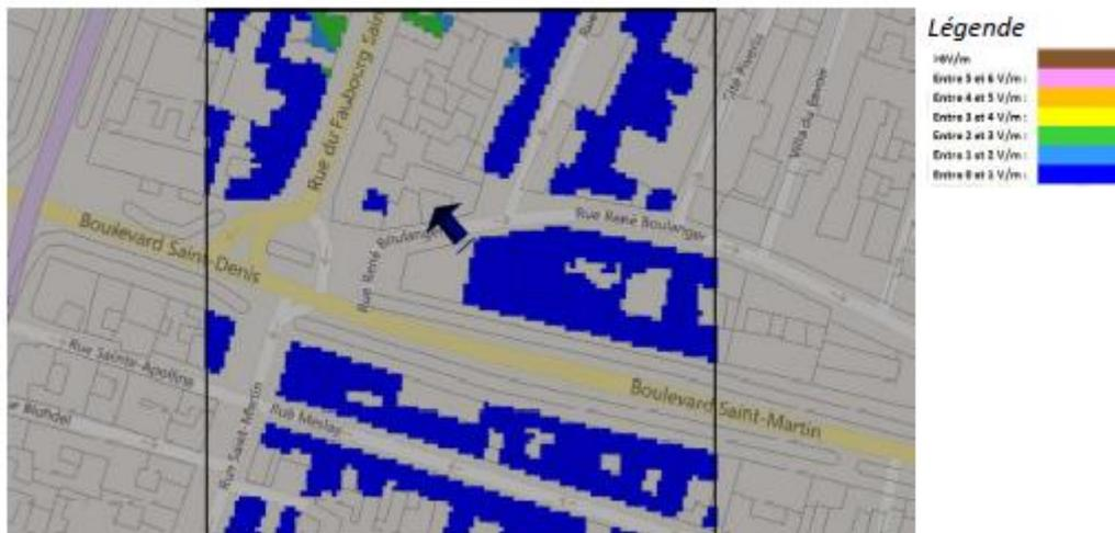
Pour l'antenne orientée dans l'azimut 217°, le niveau maximal calculé est compris entre 2 et 3 V/m. La hauteur correspondante est de 19.5 m.
