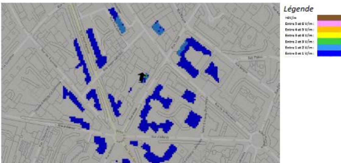
*Pour les antennes à faisceau orientable dans l'azimut 120°, le niveau maximal calculé est compris entre 4 et 5 V/m . La hauteur correspondante est de 22.5 m .*
