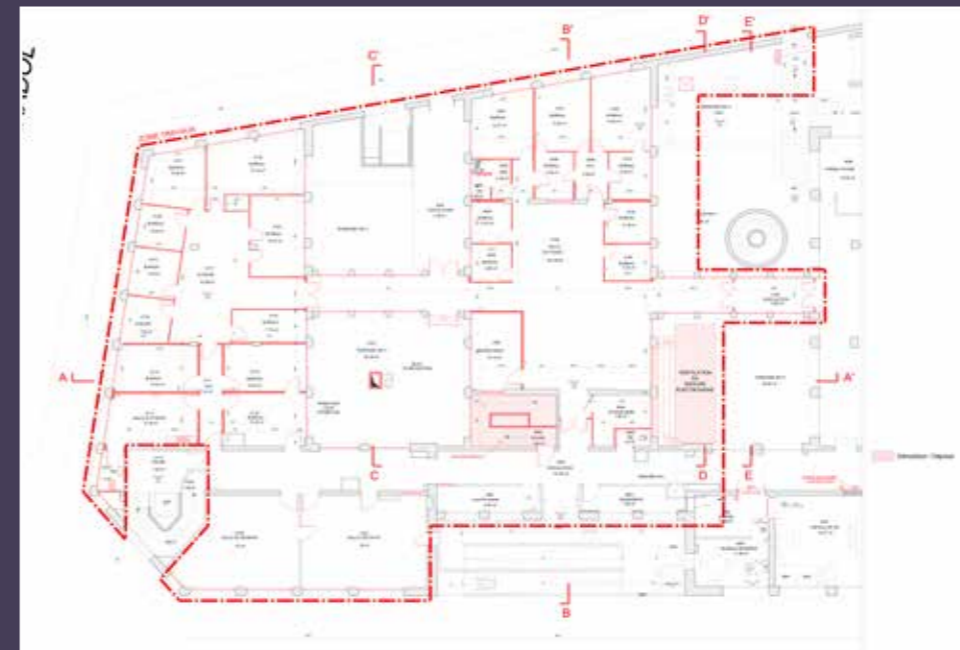
Plan du rez-de-chaussée, état existant avec indication en rouge des démolitions prévues (© E. Dardy / M. Tirel).
