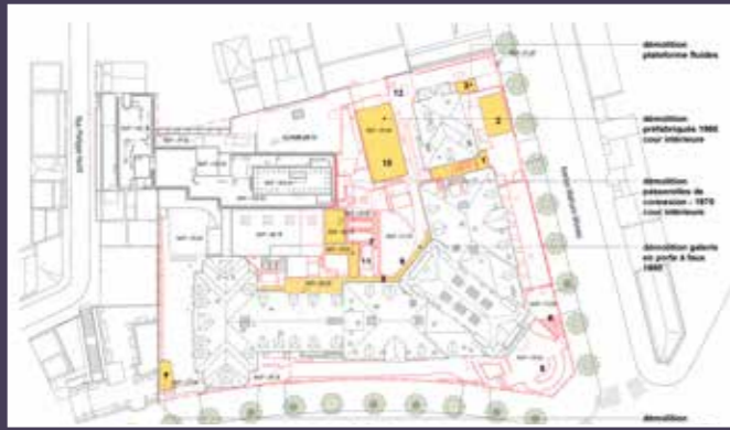
Plan-masse des constructions à démolir (© Brunet-Saunier Architecture).
