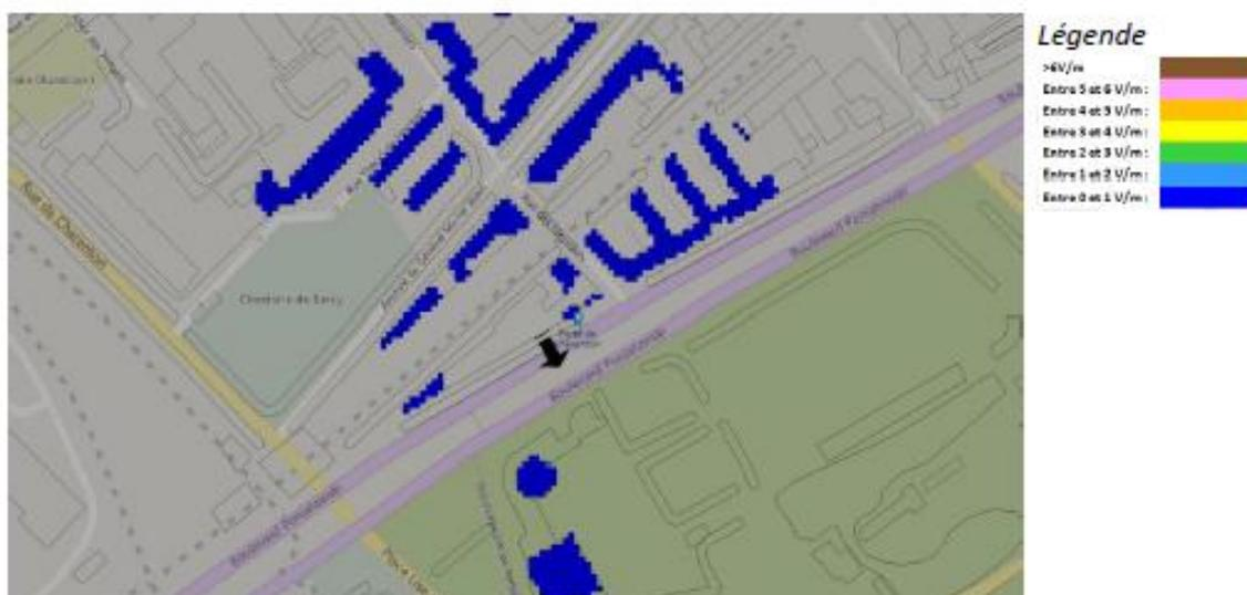
*Pour les antennes à faisceau orientable dans l'azimut 265°, le niveau maximal calculé est compris entre 1 et 2 V/m . La hauteur correspondante est de 19.5 m .*
