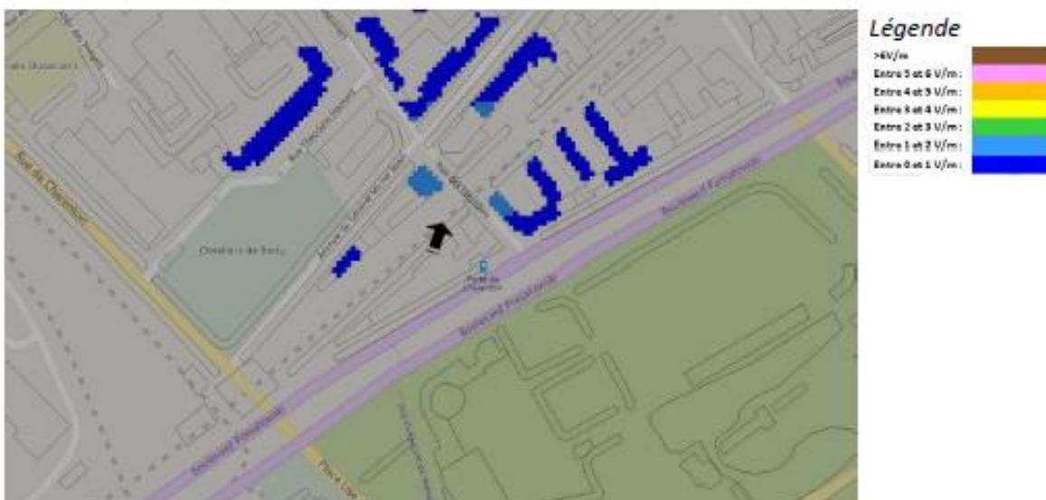
*Pour les antennes à faisceau orientable dans l'azimut 150°, le niveau maximal calculé est compris entre 1 et 2 V/m . La hauteur correspondante est de 7.5 m .*
