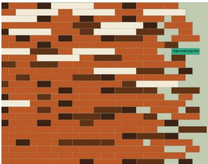
Sol briques + pierres d'Euville posées sur chants à joints vifs :
