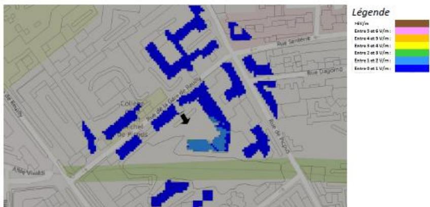
Pour les antennes à faisceau orientable dans l'azimut 240°, le niveau maximal calculé est compris entre 1 et 2 V/m . La hauteur correspondante est de 13.5 m .
