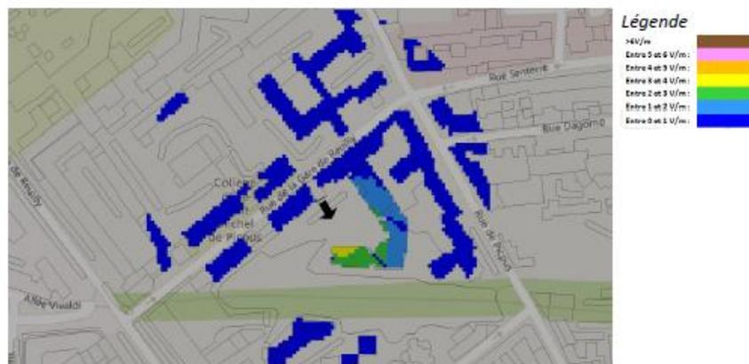
Pour les antennes à faisceau fixe orientées dans l'azimut 240°, le niveau maximal calculé est compris entre 1 et 2 V/m . La hauteur correspondante est de 16.5 m .
