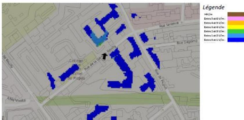
*Pour les antennes à faisceau fixe orientées dans l'azimut 150°, le niveau maximal calculé est compris entre 3 et 4 V/m . La hauteur correspondante est de 13.5 m .*
