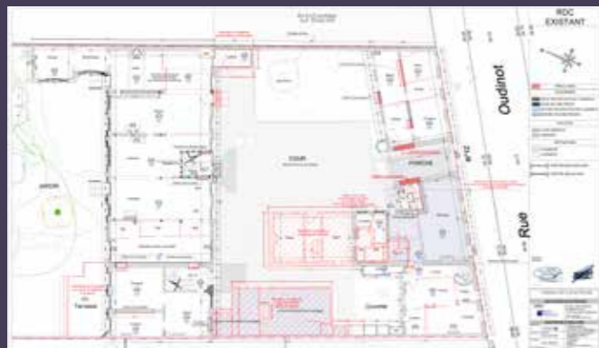
Plan du rez-de-chaussée, état existant présentant les démolitions envisagées (© Cassiopée Concept).
