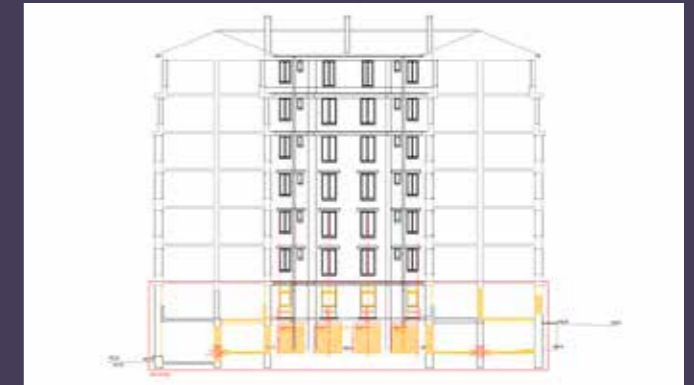
Élévation du bâtiment devant accueillir les ateliers en duplex, état existant présentant les démolitions (© Atelier Julien Boidot / Paris Habitat).
