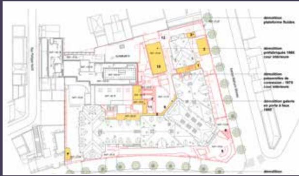
Plan-masse des constructions à démolir (© Brunet-Saunier Architecture).
