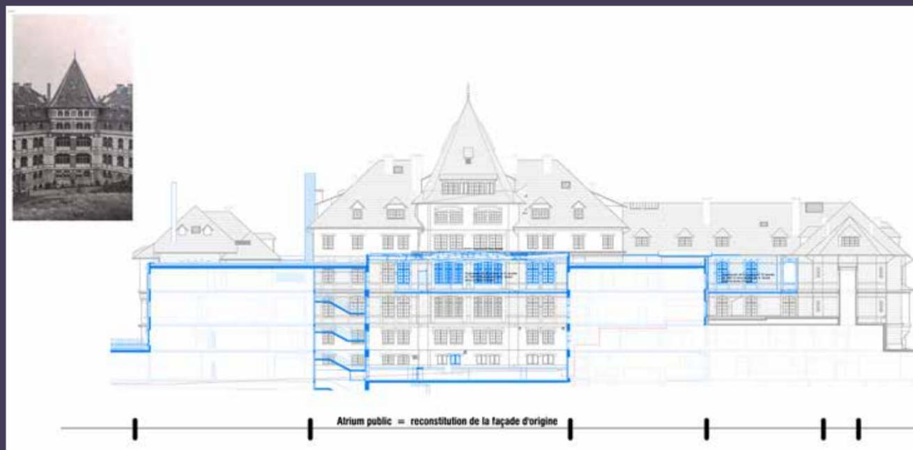
Élévation des façades intérieures, état projeté (en bleu les nouvelles réalisations) (© Brunet-Saunier Architecture).
