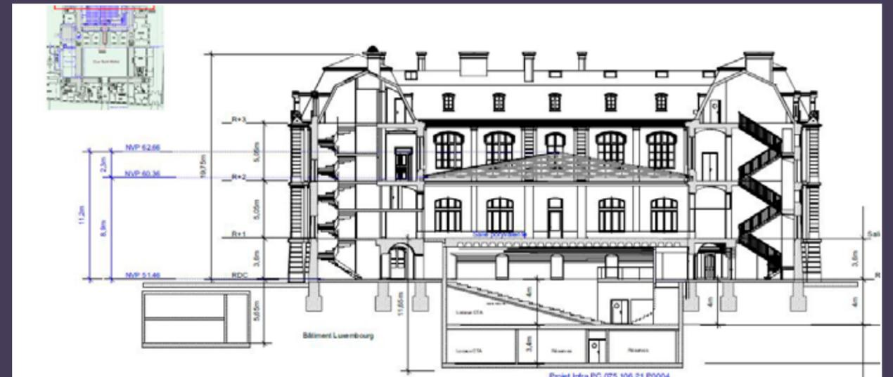
Coupe longitudinale de la cour Luxembourg, état projeté avec remplacement de la couverture existante par une verrière (projet à déposer successivement avec permis modificatif) (© Jean Marc Deram Architecte).
