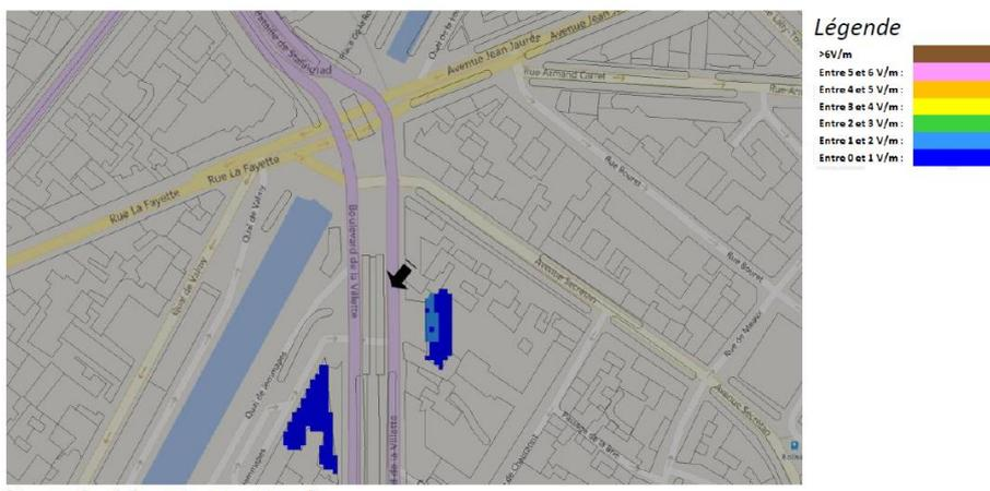
Pour les antennes à faisceau fixe orientées dans l'azimut 330°, le niveau maximal calculé est compris entre 1 et 2 V/m . La hauteur correspondante est de 16.5 m .
