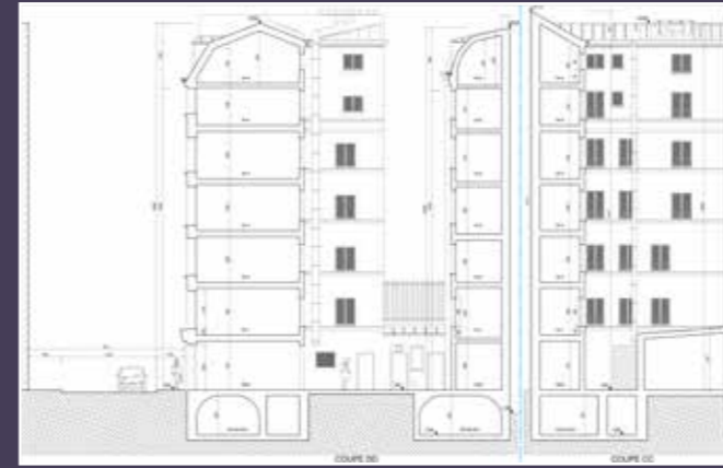
Coupes longitudinale et transversale, état existant (© FDLArchitecte - Florian de Langsdorff).
