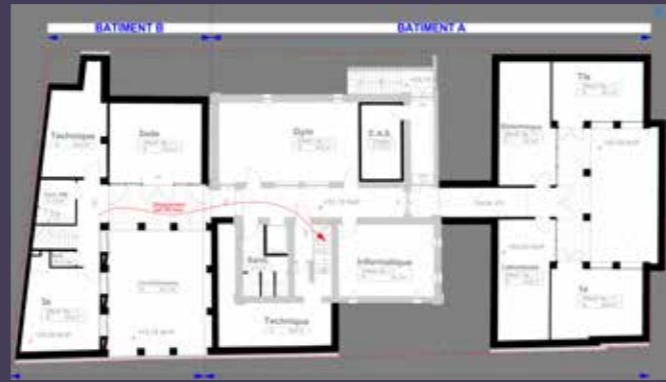
Plan projet pour le sous-sol avec indication des extensions en noir (© Zoom Factor Architectes).
