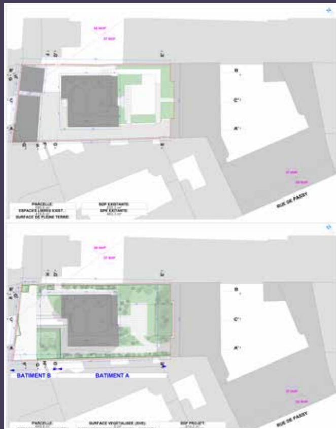
Plan masse, état existant (en haut) et projet (en bas) (© Zoom Factor Architectes).
