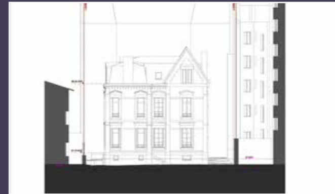
Coupe de l'existant le long de la façade arrière de l'hôtel (© Zoom Factor Architectes).
