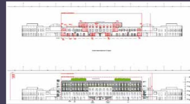
Élévation de la façade principale, état existant présentant les démolitions envisagées (en haut) et état projeté (en bas) (© Atelier Georges / Calq architecture).
