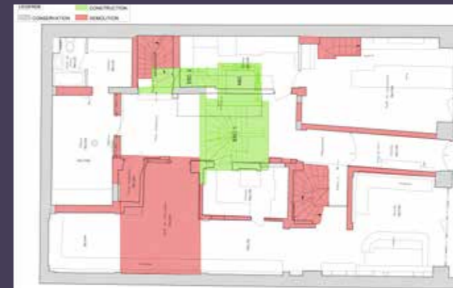
Plan du RDC présentant les démolitions (en rouge) et les constructions (en vert) (© FDLArchitecte - Florian de Langsdorff).
