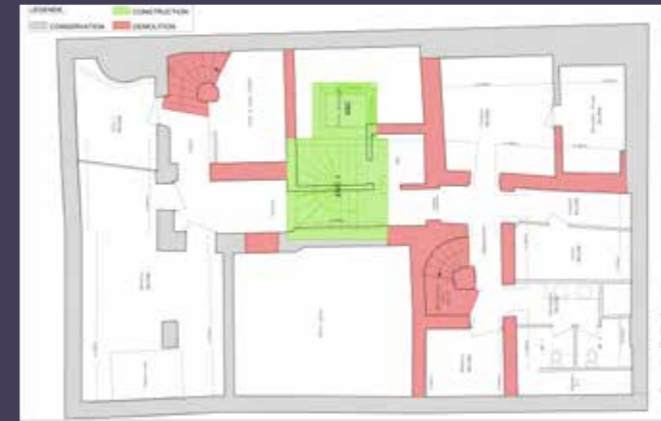
Plan du sous-sol présentant les démolitions (en rouge) et les constructions (en vert) (© FDLArchitecte - Florian de Langsdorff).
