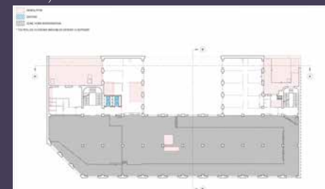
Plan du 1 er étage, repérage des démolitions (© B. architecture).
