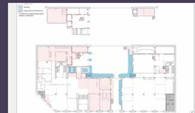
Plan du rez-de-chaussée, repérage des démolitions (© B. architecture).
