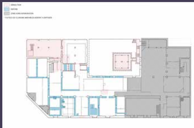
Plan du sous-sol, repérage des démolitions (© B. architecture).
