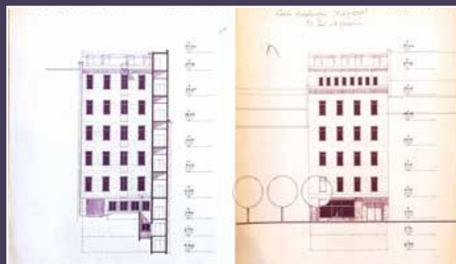
Élévation des façades sur cour (à gauche) et sur le boulevard (à droite), deuxième version, 1963 (Archives de Paris).
