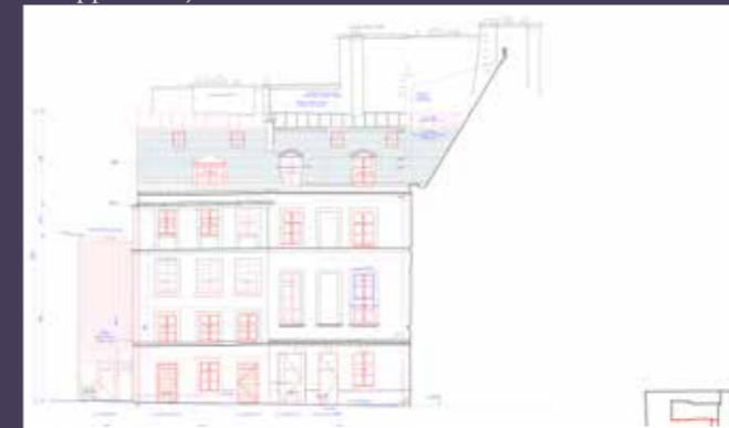
Élévation de la façade de l'aile sud, état projeté (© Atelier Philippe Prost).
