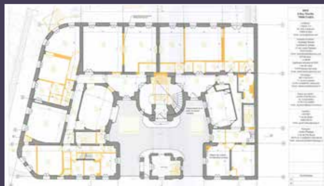
Plan de démolitions, rez-de-chaussée (© Atelier JA, mai 2021).
