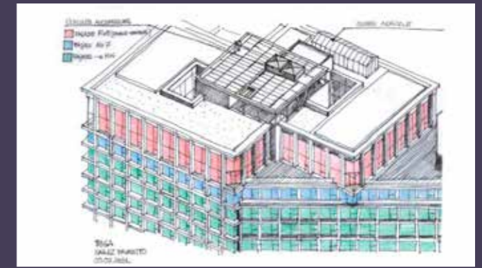
Axonométrie du projet des façades et derniers niveaux (© Favretto architecte).
