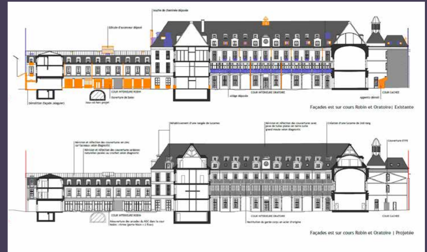
Élévation des façades est sur les cours Robin et Oratoire, état existant présentant les démolitions envisagées (en haut), état projeté (en bas) (© Atelier Monchecourt & Co).
