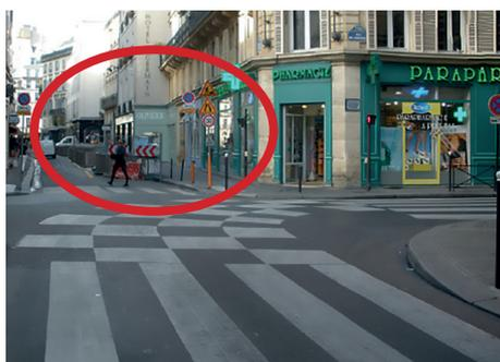
Seulement pour les voies limitées à 50km/h, positionner le Totem en amont du chantier si possible entre la 1<sup>ère</sup> barrière de l'emprise et le carrefour.
