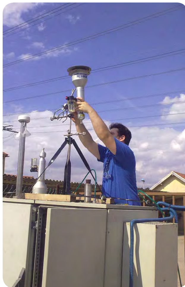
Montage d'une station de prélèvement
