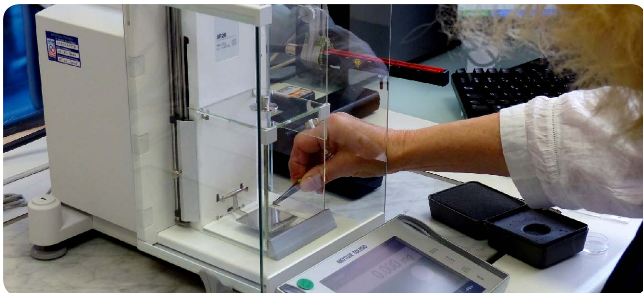
Application d'un poids de contrôle sur une microbalance
