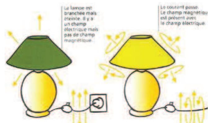
Exemple de champ électrique et champ magnétique (Source : tenormelec.com)
