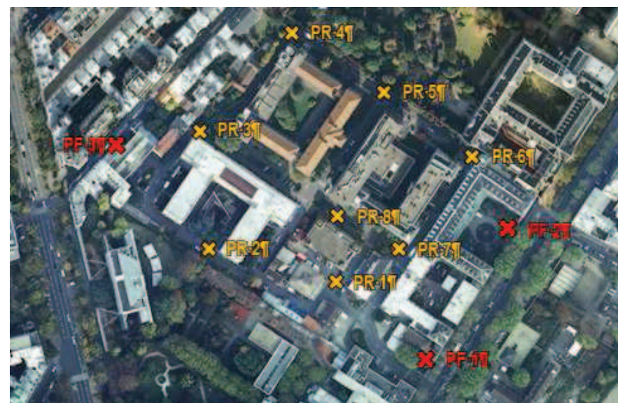
Localisation des points de mesures acoustiques (Source : Etat initial, Impédance, 2014)
