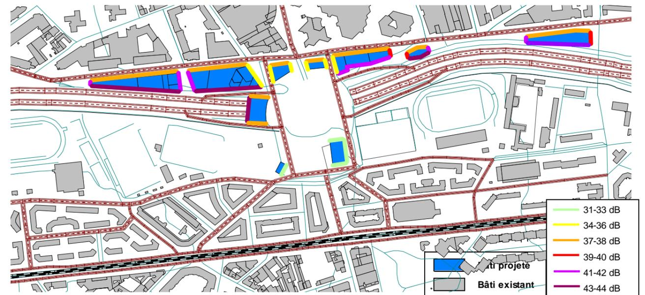
Figure 5 : Visualisation des isolements acoustiques minimaux supérieurs à 30 dB(A) requis par le classement sonore des voies et les voies nouvelles. Source : Etude acoustique de la Porte de Montreuil. Acouphen.
