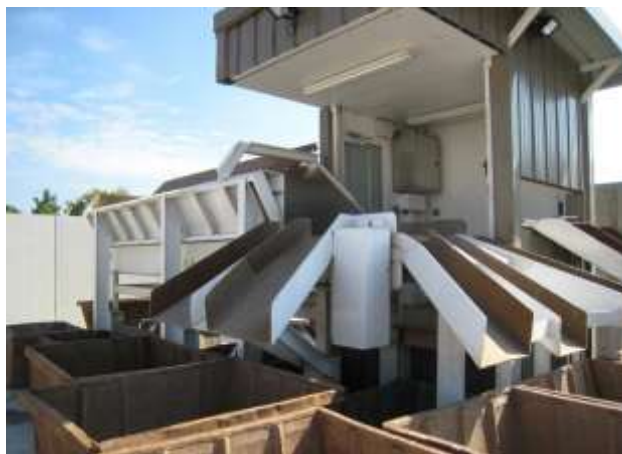
Photographie 3 : Appareil de tri des pavés à la DVD
