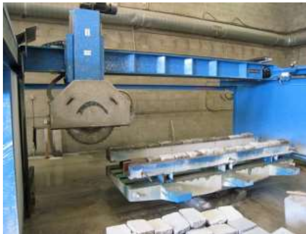
Photographie 2 : Atelier de sciage des bordures et pavés de la DVD
