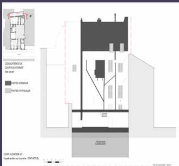
Vue de la façade arrière et coupe sur la courette, démolitions (© Lagneau architectes 2021).
