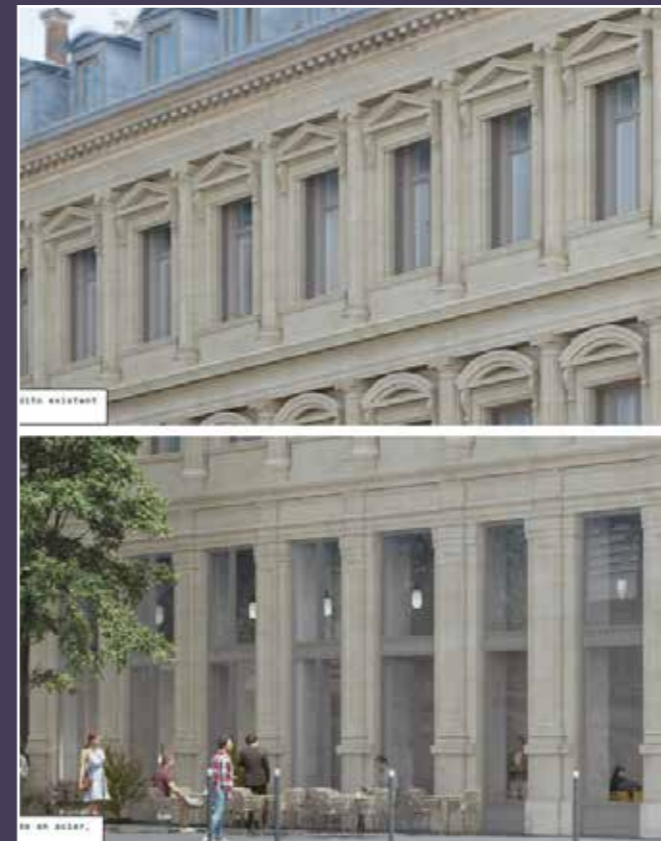
Vue d'insertion des allèges et menuiseries (© Atelier Senzu).
