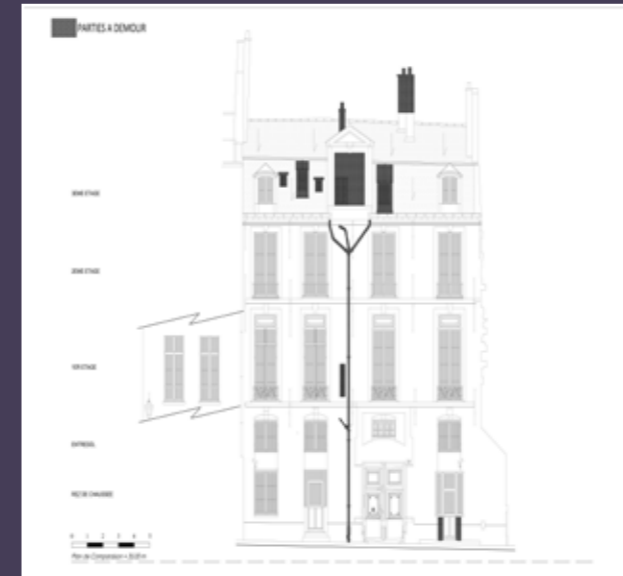
Élévation sur rue, démolitions (© Lagneau architectes 2021).
