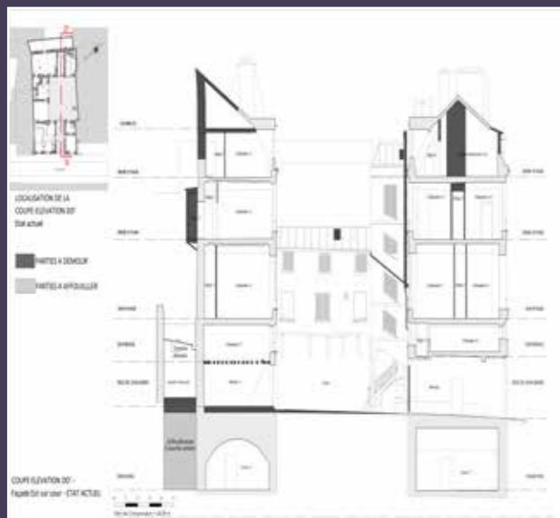
Coupe vers l'aile sud, démolitions (© Lagneau architectes 2021).
