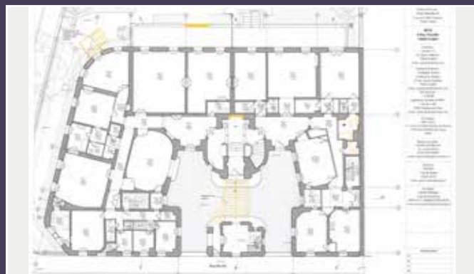
Plan du rez-de-chaussée, état actuel présentant les démolitions envisagées, nouveau projet (© Atelier JA).
