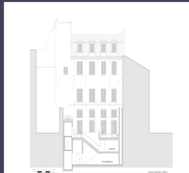
Vue de la façade arrière et coupe sur la courette, projet (© Lagneau architectes 2021).
