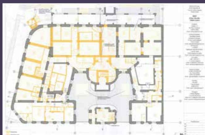
Plan de démolitions du R-1, projet présenté en septembre 2021 (© Atelier JA).
