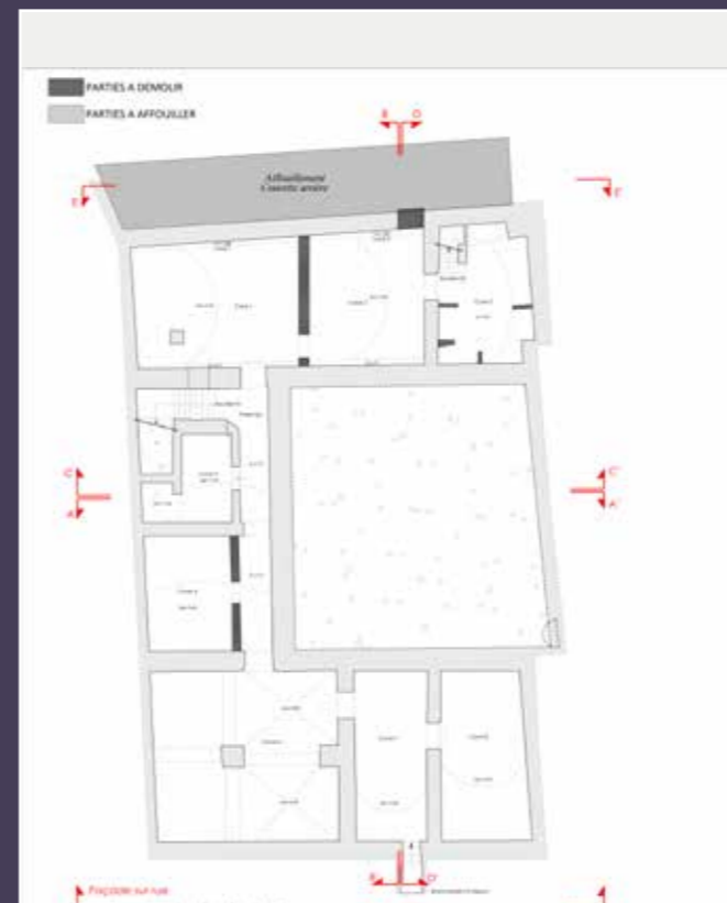
Plan des caves, démolitions (© Lagneau architectes 2021).
