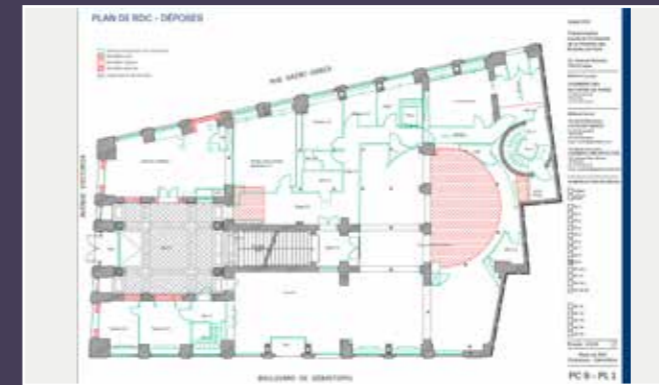
Plan du rez-de-chaussée, état actuel présentant les modifications envisagées (© Atelier Senzu).
