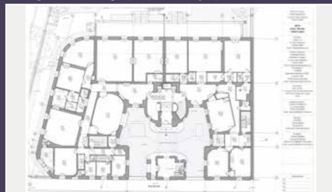
Plan du rez-de-chaussée, état projeté (© Atelier JA).
