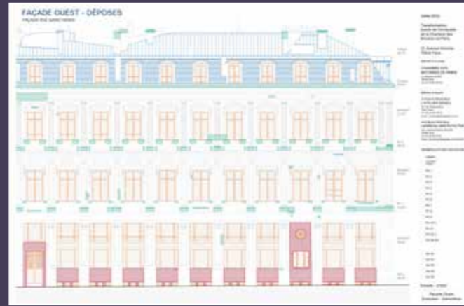
Élévation de la façade rue Saint-Denis, état existant présentant les modifications envisagées (© Atelier Senzu).
