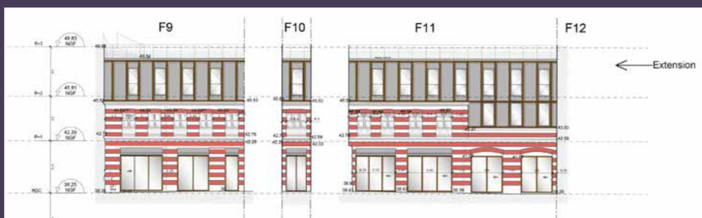
Élévation des façades des annexes, état projeté (© DTACC).
