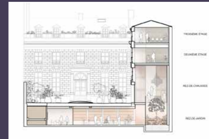
Coupe transversale sur la cour et l'aile en retour, état projeté (© Architecture Studio).
