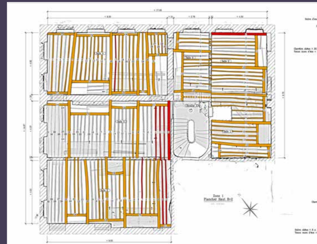
Plan présentant l'état sanitaire du plancher haut du R+2 (© ESCB).
