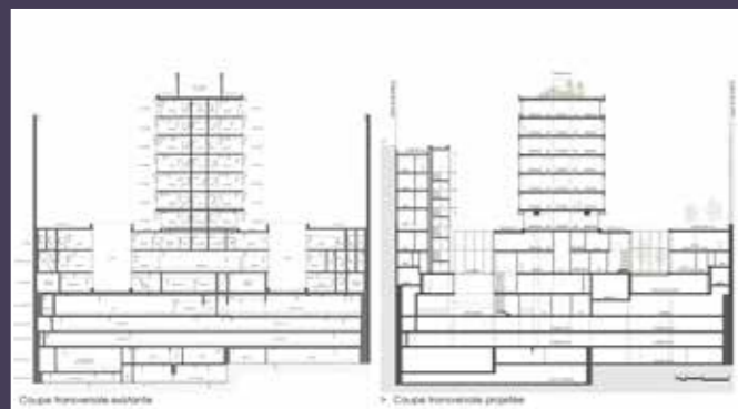
Coupe transversale, état existant (à gauche) et projet (à droite) (© DTACC).
