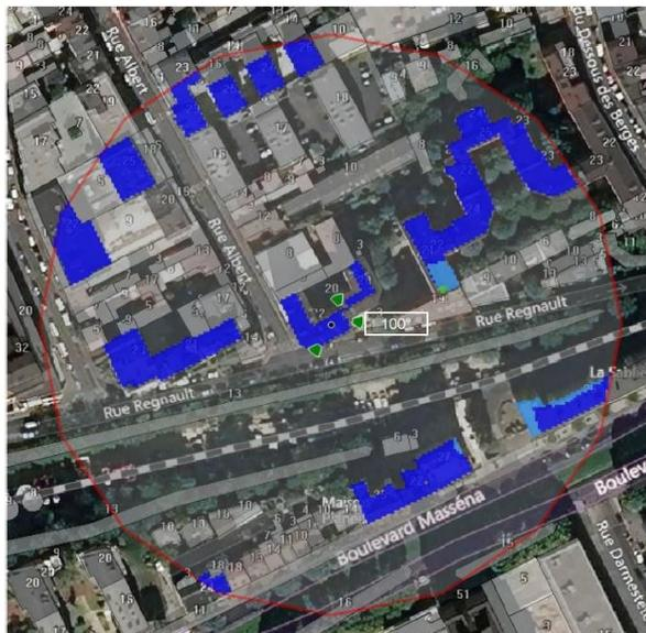
Les simulations en espace libre avec bâti simple vitrage indiquent les niveaux maximums en intérieur par antenne à faisceaux orientables :
