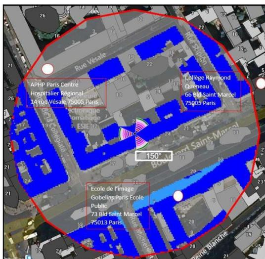
Les simulations en espace libre indiquent les niveaux maximums en intérieur par antenne à faisceaux orientables :
