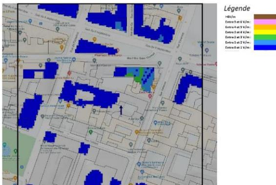
Pour l'antenne orientée dans l'azimut 240°, le niveau maximal calculé est compris entre 2 et 3 V/m. La hauteur correspondante est de 25.5m
