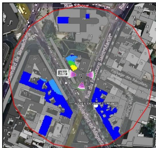
Les simulations en espace libre avec bâti simple vitrage indiquent les niveaux maximums en intérieur par antenne à faisceaux orientables :
