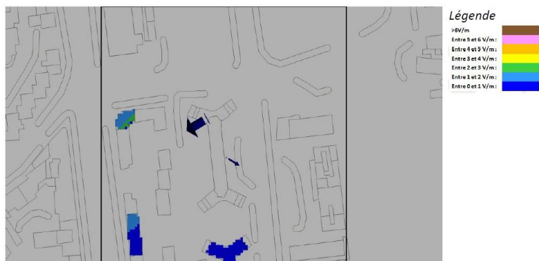
Résultats de simulation des antennes à faisceaux fixes
