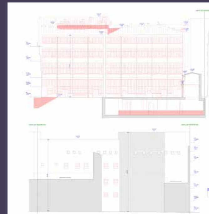
Élévation de la façade arrière, présentant les démolitions (© Mars architecte).
