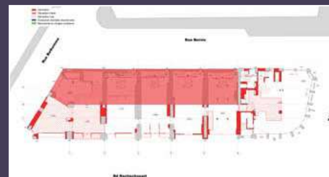
Plan des démolitions prévues au rez-de-chaussée (© Studio Belem).
