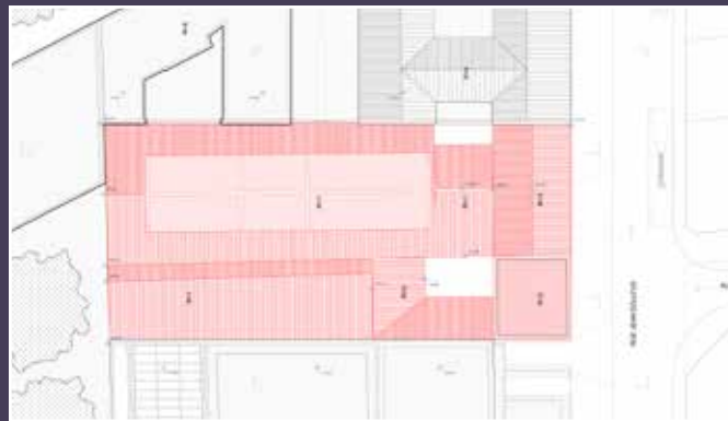
Plan des démolitions prévues, correspondant à l'intégralité de la parcelle (© Barrault Pressacco).
