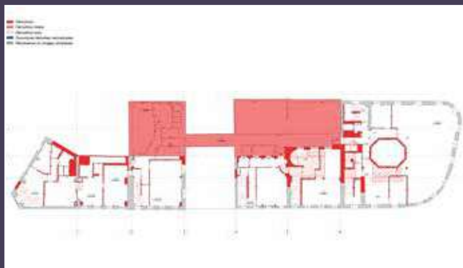
Plan des démolitions prévues au R+3 (© Studio Belem).
