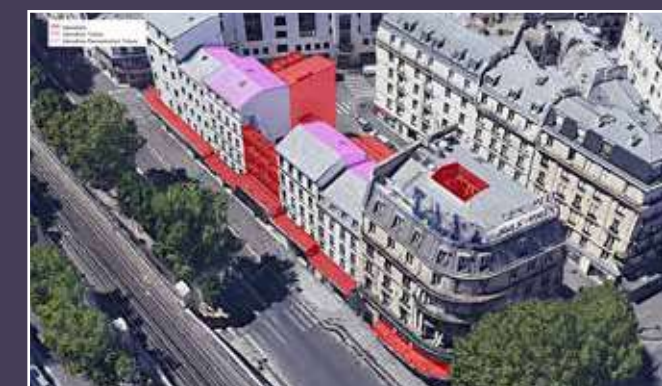
Vue aérienne présentant les démolitions prévues (en rouge), les toitures démolies (en violet) et les toitures démolies et reconstruites (en violet clair) (© Studio Belem).
