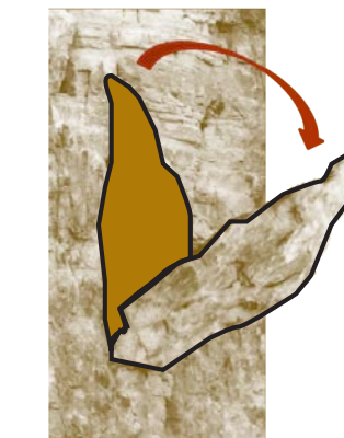
La partie fragilisée se détache...
