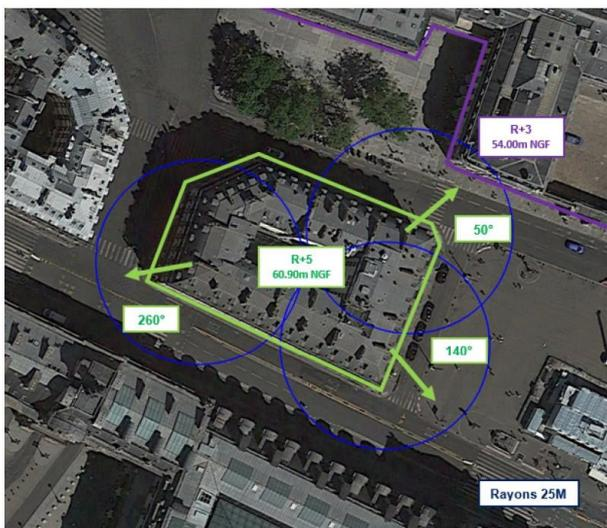
**Simulation et conformité au seuil de la Charte en 3G/4G/5G Faisceau fixe**
