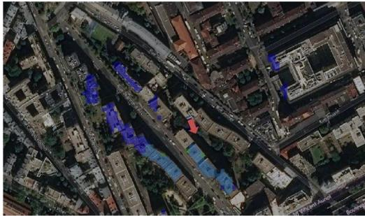
Pour les antennes à faisceau orientable dans l'azimut 300°, le niveau maximal calculé est compris entre 2 et 3 V/m . La hauteur correspondante est de 21.5 m .
