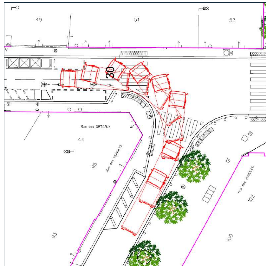
Giration d'un poids lourd au carrefour Rue des Vignoles / Rue des Orteaux
