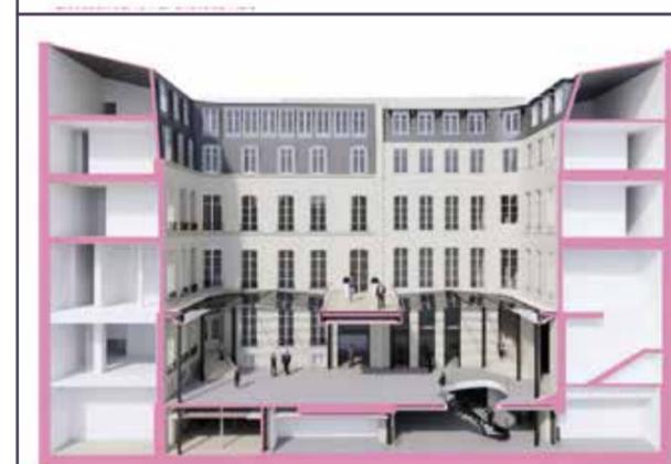
En haut, dégagement de la cour, verrière et accès au sous-sol - premier projet ayant fait l'objet de réserves; en bas, dégagement de la cour, verrière et accès au sous-sol - second projet ayant fait l'objet d'une levée des réserves (© YM Architecture).
