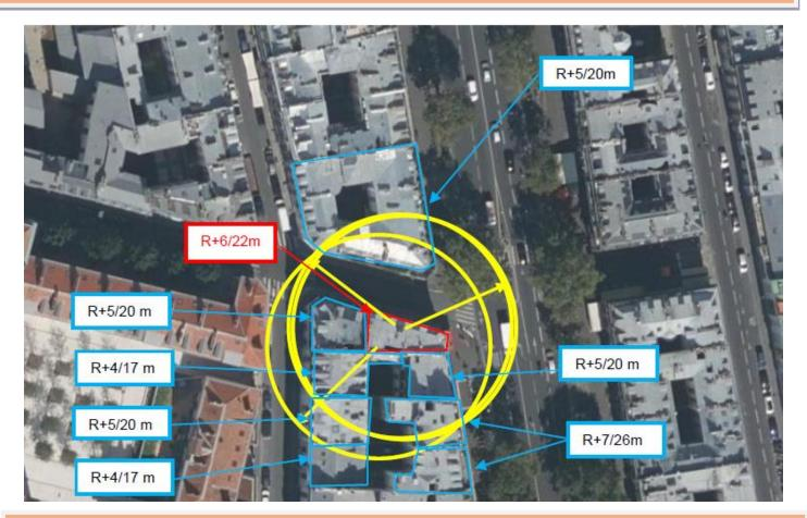
Simulation et conformité au seuil de la Charte en 2G/3G/4G/5G (2100 MHz) -Faisceau fixe
