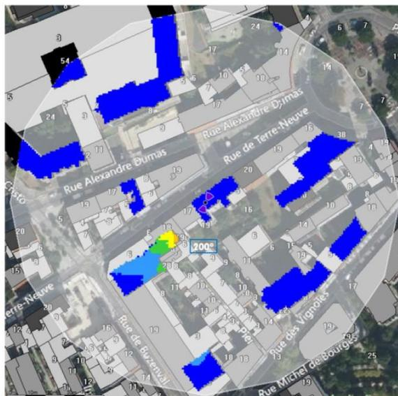
Les simulations en espace libre avec bâti simple vitrage indiquent les niveaux maximums en intérieur par antenne à faisceau fixe :
