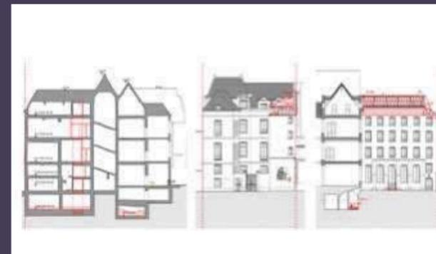
Coupes et élévations des façades avec repérage des démolitions (© Biecher Architectes).
