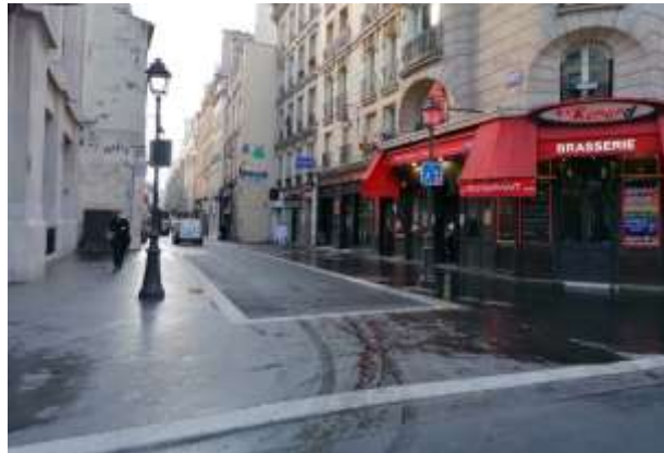
Exemple d'un trottoir traversant
