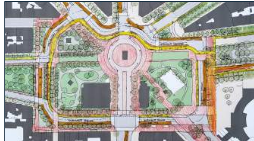
Document de travail - piste cyclable 2 : Bidirectionnelle au nord de la place, unidirectionnelle au sud
