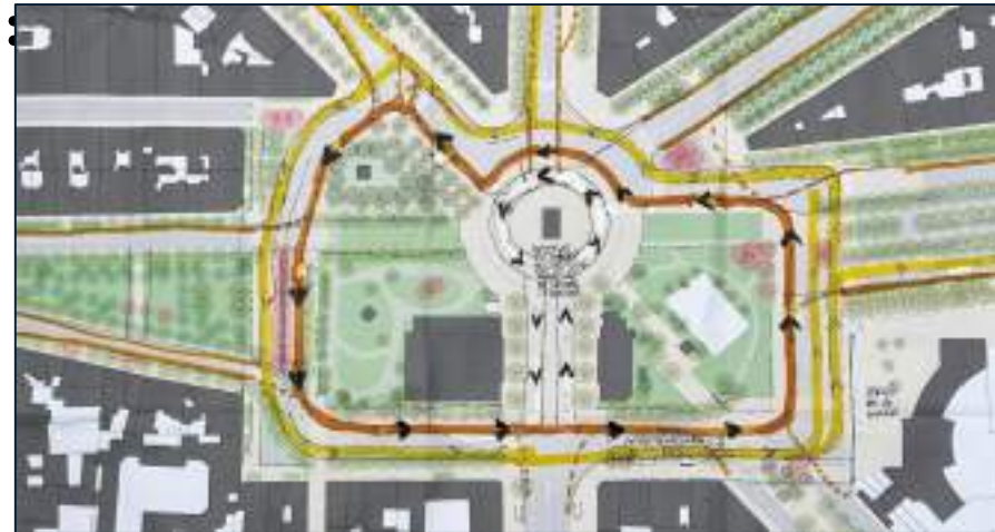
Document de travail - piste cyclable 1 : uni directionnelle, contournement intérieur de la place
