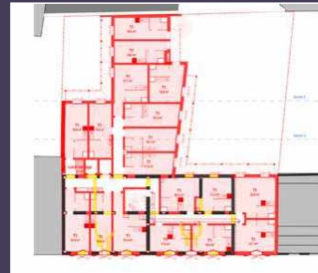
Plan du R+1 indiquant les démolitions (en jaune) et les nouvelles constructions (en rouge) (© Antonini Architecte associés).
