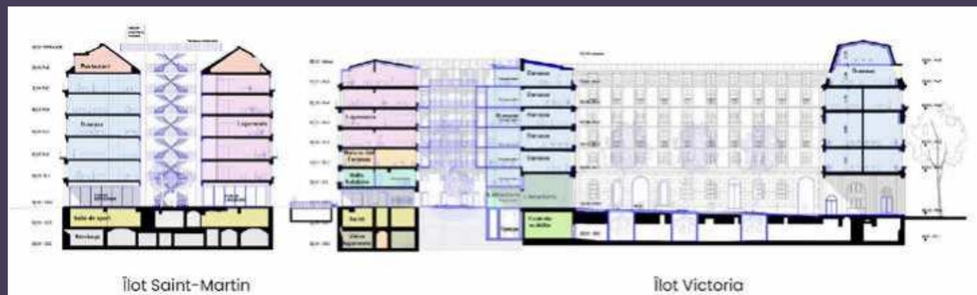
Coupe sur l'ensemble, projet présenté au stade de la faisabilité (© « Hospitalités citoyennes »).
