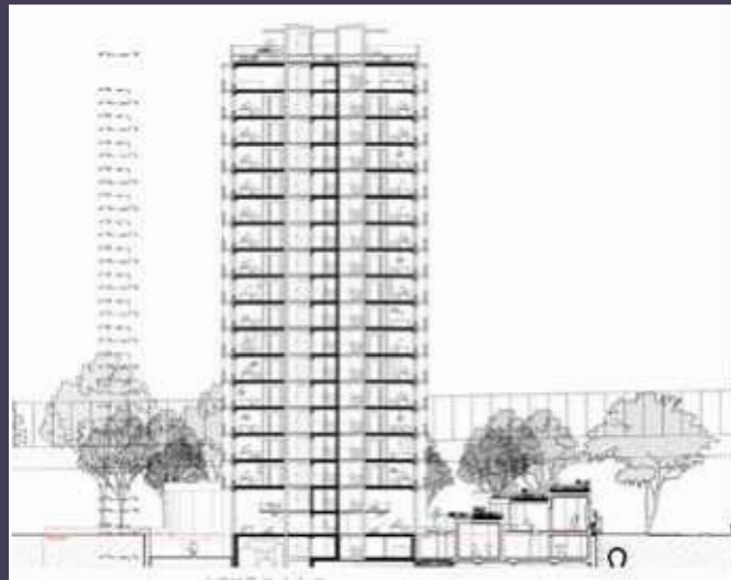
Coupe longitudinale, état projeté présentant les extensions de plancher et les studios d'enregistrement (© AUC architectes).
