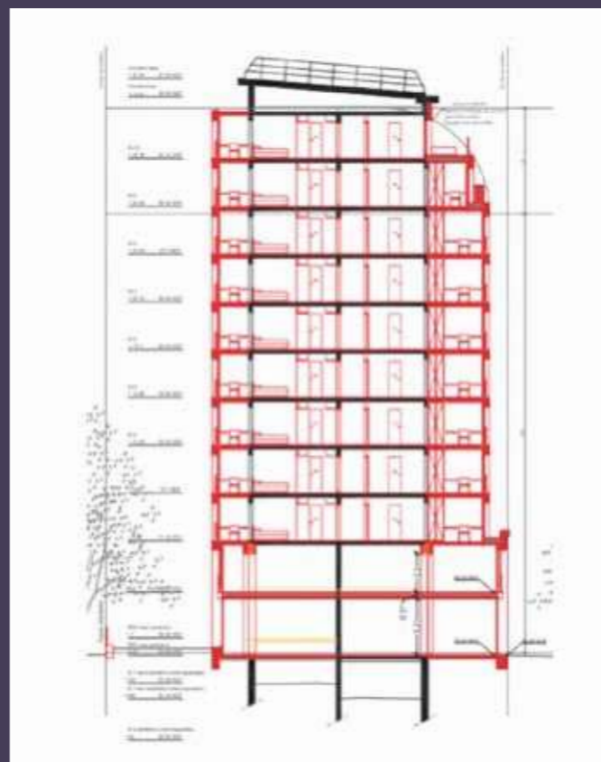
Coupe présentant le principe d'intervention sur la cage D dédiée à la résidence étudiante (© MG-AU / JBMN architectes).
