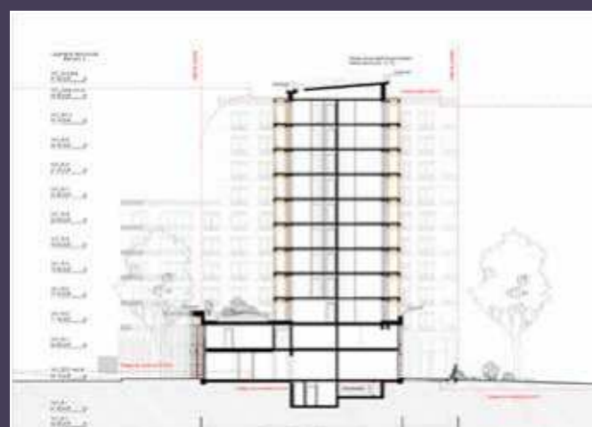
Coupe sur l'extension de la barre par des balcons filants (© MG-AU / JBMN architectes).
