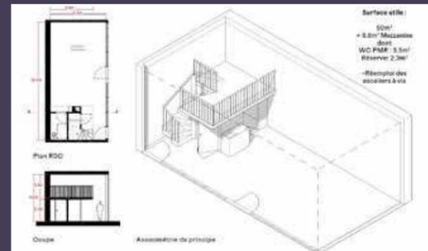
Présentation d'une des typologies des ateliers à RDC, avec réemploi des escaliers à vis (© rh+ architecture).
