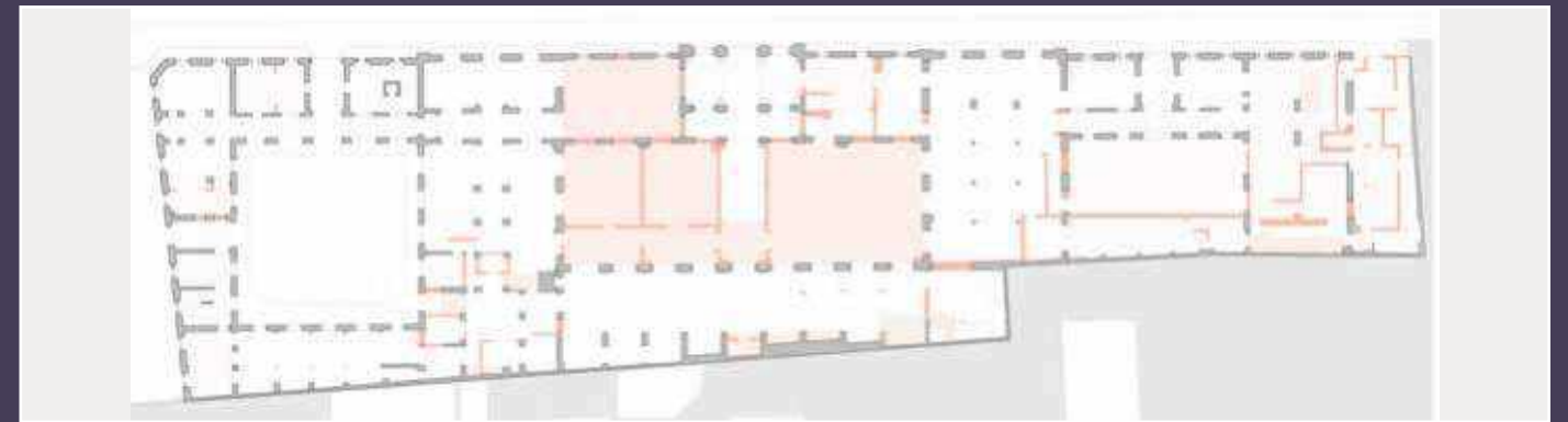
Plan des démolitions prévues au rez-de-chaussée (© Perrot & Richard Architectes).
