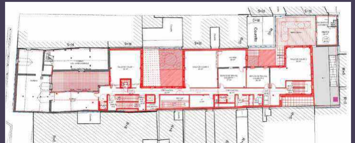
Plan du R+3 présentant en rouge les éléments ajoutés et en gris les éléments existants (© Wilmotte & associés / Serge Caillaud architecte).
