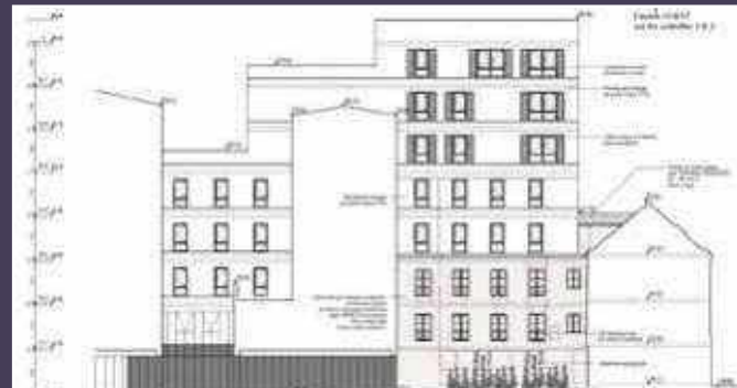
Élévation des façades ouest sur les cour 1 et 2. Au centre, le bâtiment-pont après surélévation (© Wilmotte & associés / Serge Caillaud architecte).
