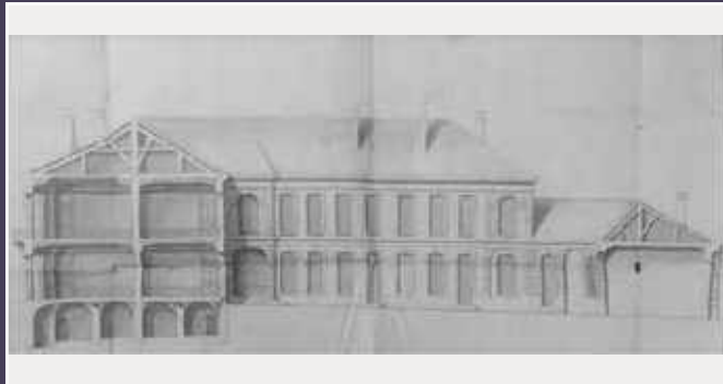
Coupe sur le corps de logis principal et sur la porte-cochère, et élévation de l'aile en retour sur la cour d'honneur, Pierre Boscry, architecte, 1731 (AN).
