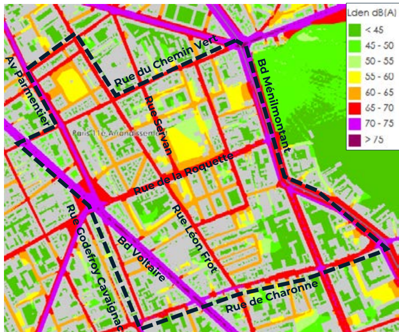
Carte des niveaux sonores enregistrés dans l'espace public (Indicateur de bruit Lden sur une journée complète)
